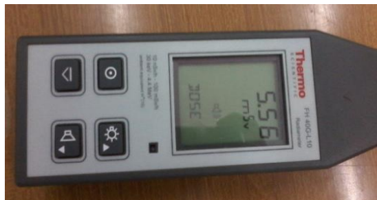
Figure III. 7: le radiomètre de type FH40 utilisé pour la mesure de débit d'équivalent de dose d'ambiance H^*(10)
