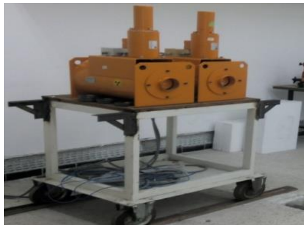
Figure III. 4: la source de Cs-137 utilisée pour les irradiations des dosimètres
