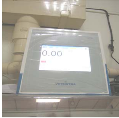
Figure III.4 : Système de lecture de l'activimètre utilisé au Service de Médecine Nucléaire (CHU Bab-El Oued)
