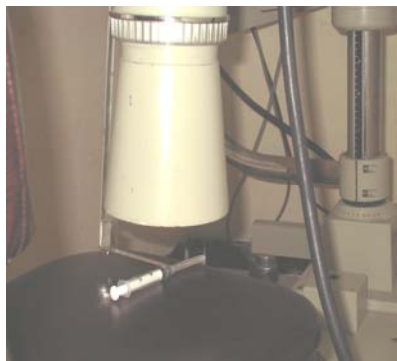
Figure III.10 : Mesure de l'activité d'une seringue à l'aide de la sonde
