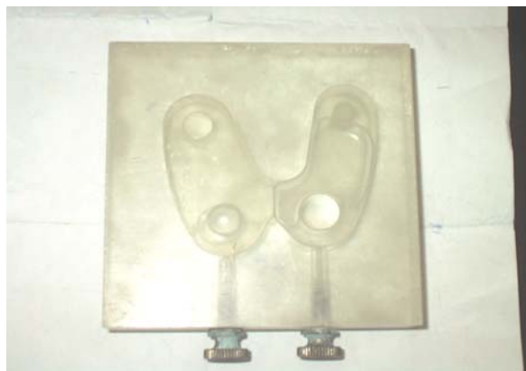
Figure III.9 : Fantôme en plexiglas pour simuler la glande thyroïde
