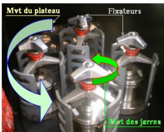
Figure II-4: Présentation schématique du mouvement du plateau et les jarres.
