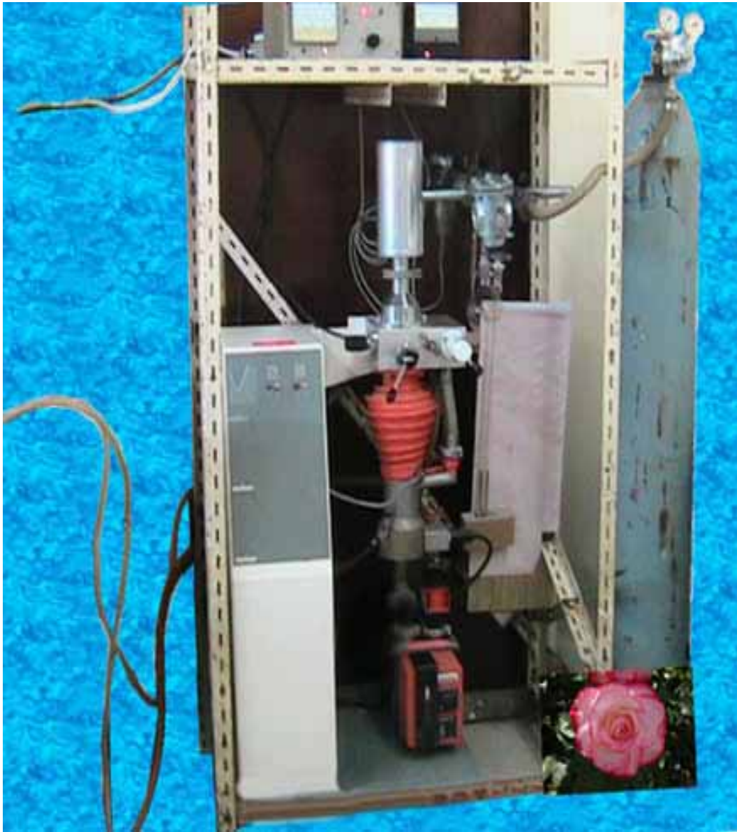
Figure V.23. Photo de l'installation d'adsorption réalisée
