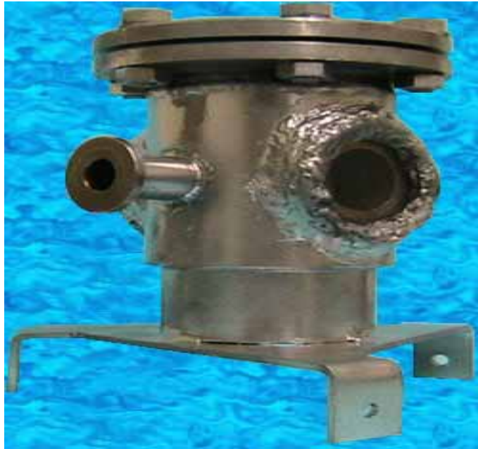
Figure V.9. Photo de la cellule d'infrarouge sur le support réalisé.
