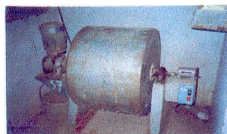
Fig. 5-1 : Essai de Los Angeles
