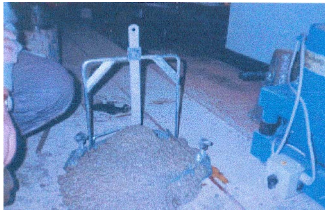
Fig. 6-2 : Essai au cône d'abrams
