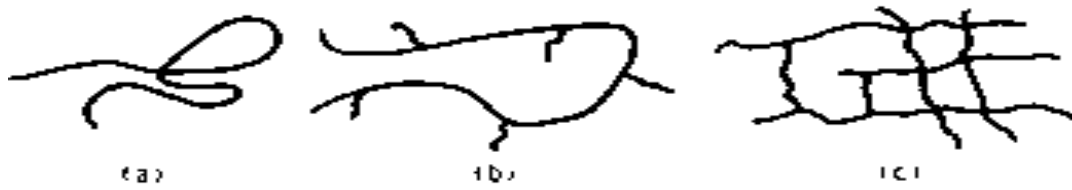
Figure 2. Représentation schématique des molécules polymères: (a) linéaire (b) ramifiée (c) tridimensionnelle (réticulée)
