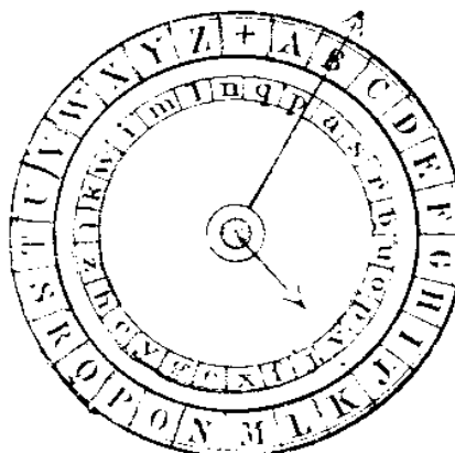
Le cryptographe de Wheatstone (alphabet clair à l'extérieur, cryptographique à l'intérieur)
