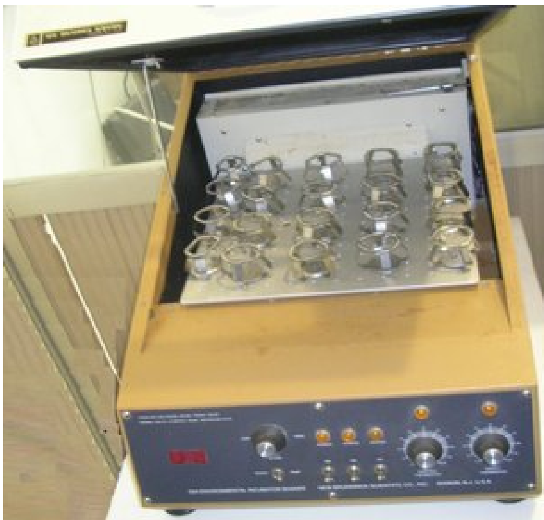
Figure (13) : photographie de l'incubateur Shaker G24, utilisé pour l'agitation des solutions
