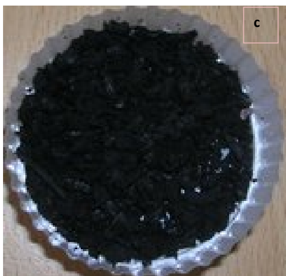
Tiges de dattes imprégnées à l'acide phosphorique 50%
