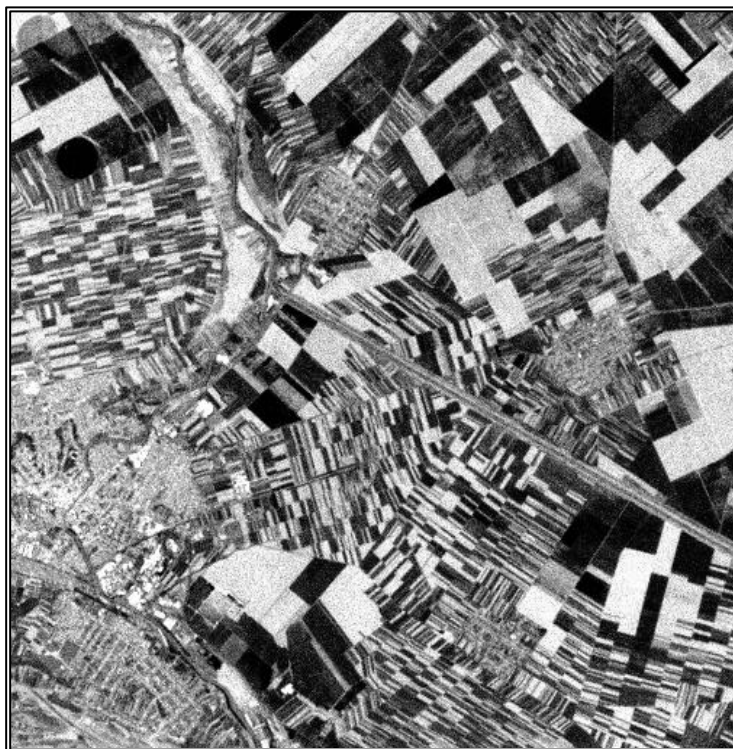
Figure 25. Première image composante principale obtenue de la scène Novi Sad et Belgrade obtenue à partir de l'ACP à bruit ajusté des bandes spectrales bruitées.
