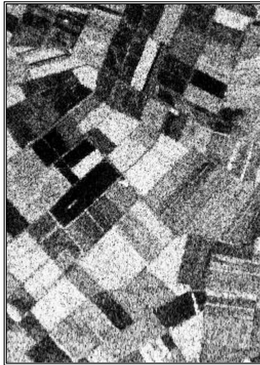
Figure 11. Image SAR du système AirSAR (bande L polarisation HV) représente une scène d'étude de 250x350 pixels d'une région agricole située près de Feltwell en Royaume Uni. (tous droits réservés à Hunting Technical Services Ltd. (UK) ).
