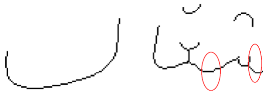
FIGURE 3.13 – Les résultats obtenus par le deuxième traitement concernant la correction des chemins du squelette.
