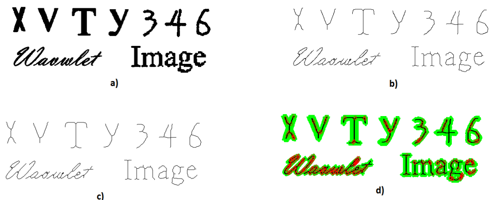
FIGURE 6.7 – Zhang & Suen Improved a) Latin et chiffres arabes b) Squelette avec Zhang & Suen c) Squelette avec Zhang & Suen Improved d) Visualisation (en rouge) des zones affectées par le post-traitement.
