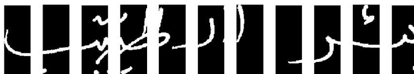
FIGURE 4.1 – Fenêtrage sur un mot de la base IFN/ENIT avec un chevauchement de 3 pixels.
