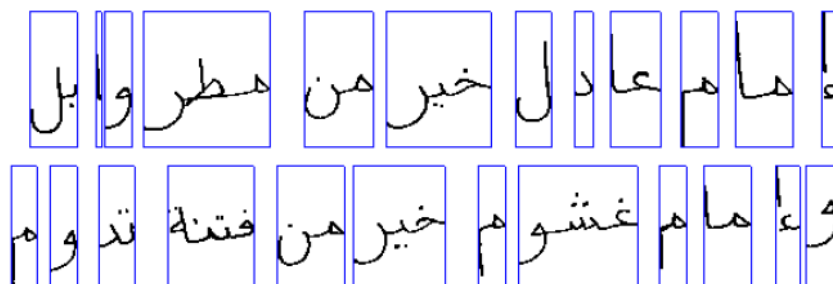
FIGURE 5.7 – Segmentation verticale après une segmentation horizontale
