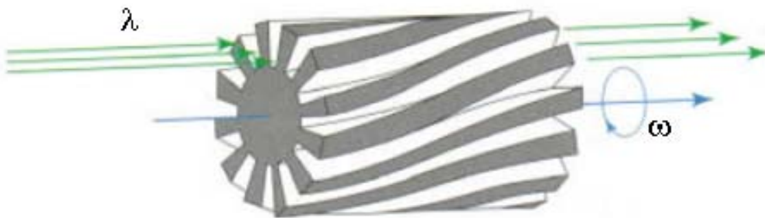
Figure III.6 : Schéma d'un sélecteur mécanique de vitesse en forme d'un cylindre muni de rainures hélicoïdales.
