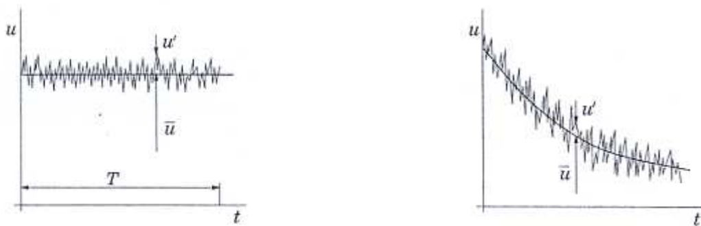
Figure (2-1): Les relations entre u , \bar{u} et u' pour flux constant (à gauche) et un écoulement instationnaire (à droite)
