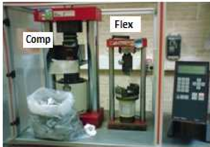
Figure IV.2 - Machine d'essai de compression et de flexion des mortiers (EN 196-1)
