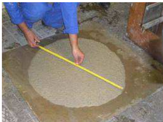
Figure IV.3 - Essai d'étalement au cône d'Abrams
