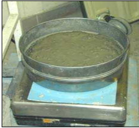
Figure IV.4 - Stabilité au tamis
