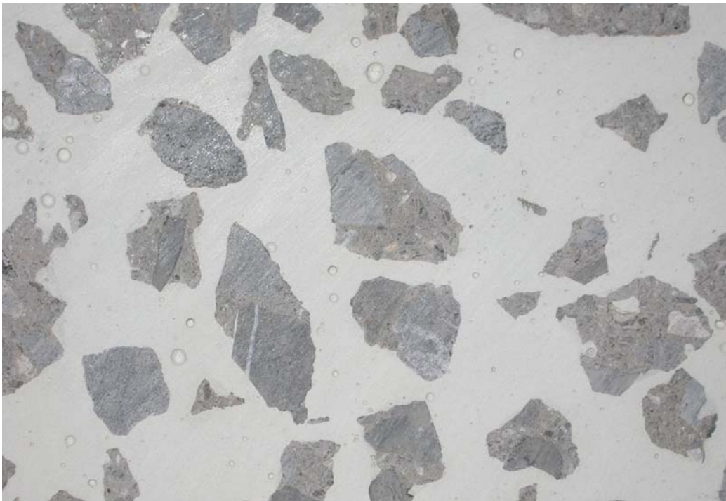
Figure V. 9 : Tranche de béton obtenu par sciage, de granulats recyclés gris dans un mortier de ciment blanc
