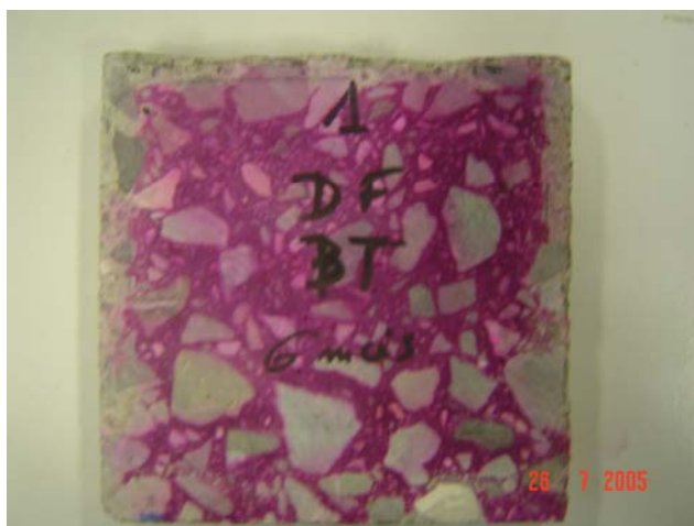
Figure IV. 15 : Visualisation de la profondeur de carbonatation d'une tranche de béton (BT) carbonatée
