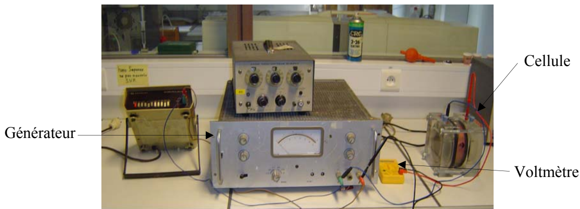
Figure IV. 17 : Dispositif de mesure de la diffusion des ions chlorures dans le béton
