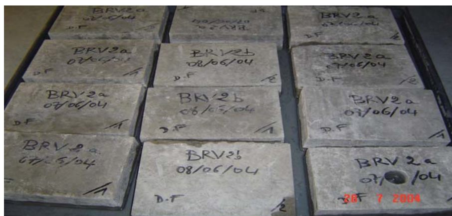
Figure IV. 4: Dalles en béton à base de 100% de gros et fins granulats naturels
