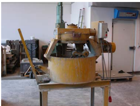
Figure IV. 2 : Malaxeur planétaire à axe vertical
