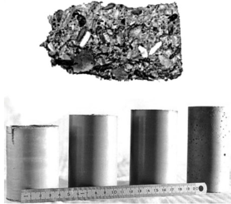
Figure 2.5: Vues à différentes échelles d'un béton [11]
