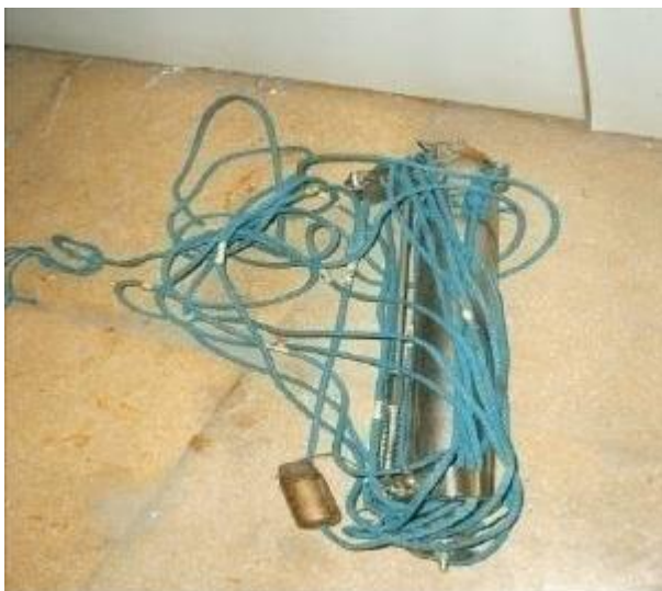
Figure N°05: bouteille de prélèvement "NISKIN" de 1 litre
