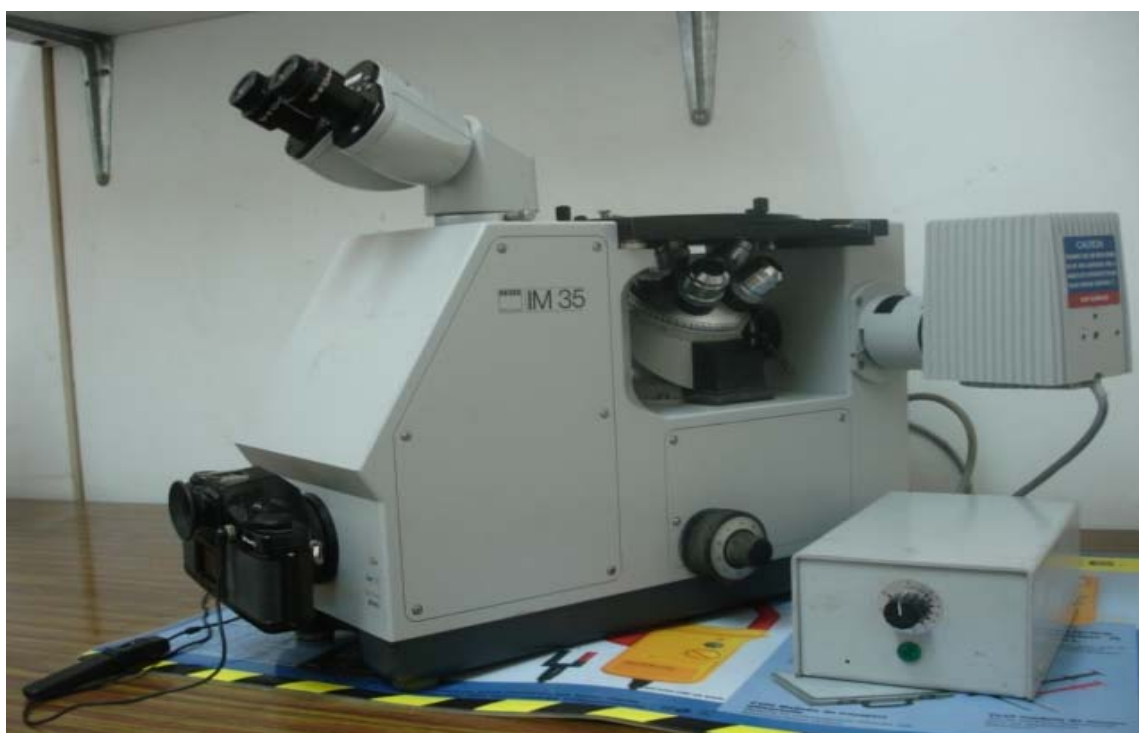
Figure III.7 : Microscope optique de type (ZEISS IM 35)
