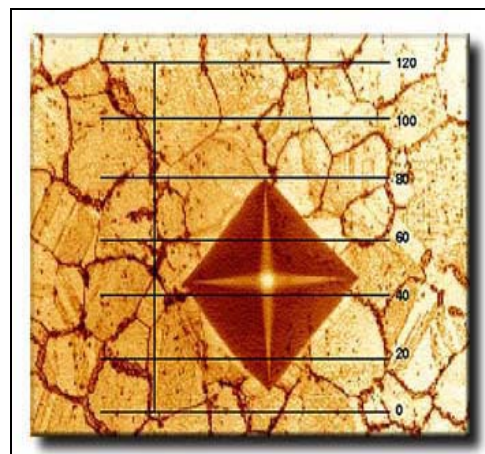
Figure III.6 : Schéma de l'empreinte
