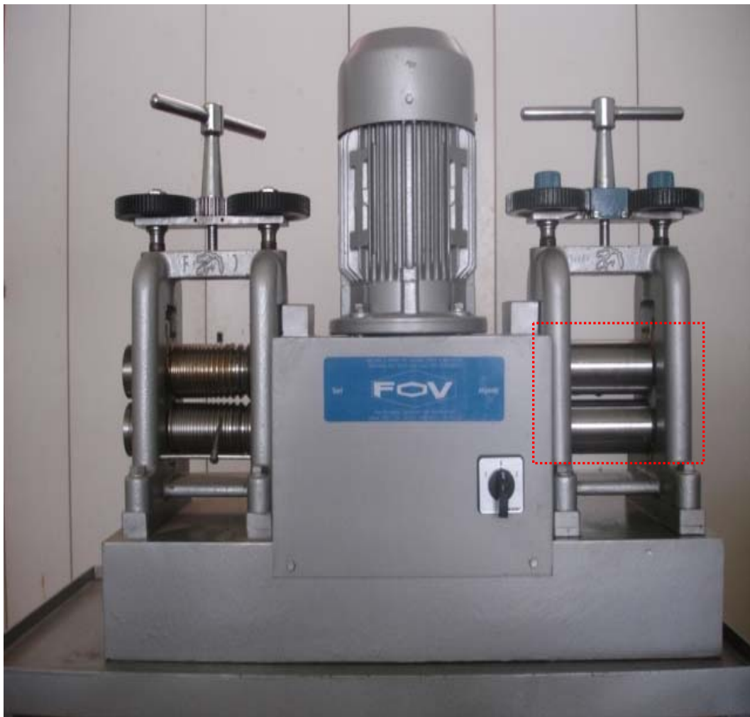
Figure III.12 : Le laminoir de type FOV
