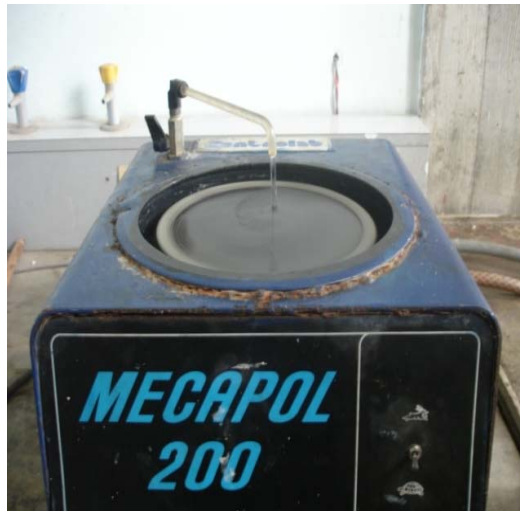
Figure III.8 : Polisseuse de type MECAPOL
