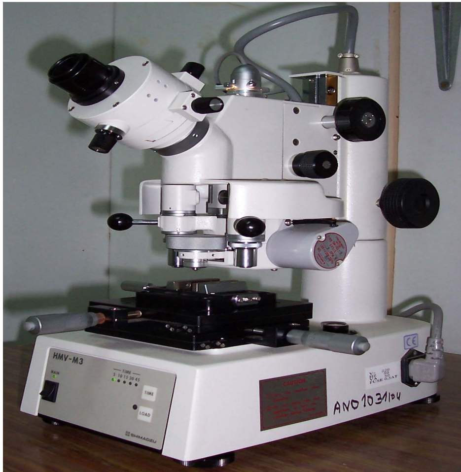
Figure III.4 : Microduremètre de type (SHIMADZU)
