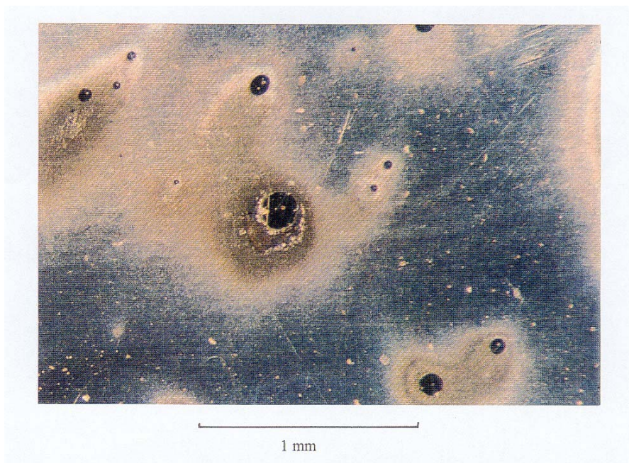
Photo N°3 : Corrosion par piqûres de l'acier à 13% Cr dans une solution NaCl 20g/l.
