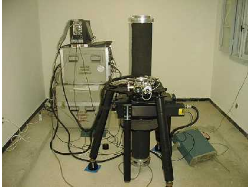
Figure 3 : Le gravimètre absolu FG5-111 (station absolue du CRAAG)
