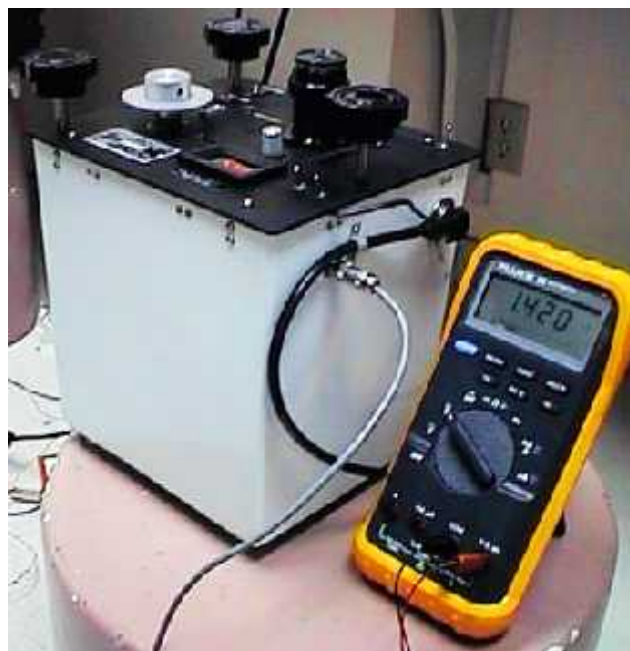
Figure 62 : Schéma du Gravimètre LaCoste &amp; Romberg équipé du MVR
