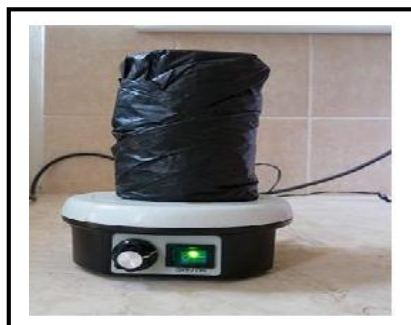
Figure IV.3 Essai d'adsorption dans le noir
