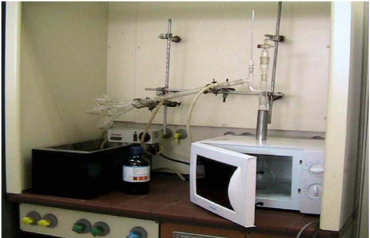
Fig. II.5 : micro – ondes domestique modifié de type (SAMSUNG M1719N de puissance 800W)
