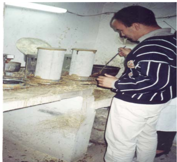
Fig.5 : Surfaçage des éprouvette
