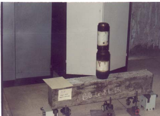
Fig.7 :Retrait des éprouvette(7*7*28)
