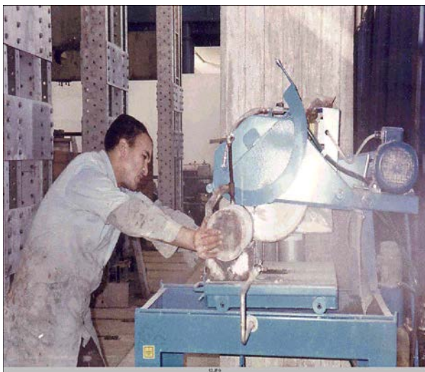
Fig.5 : Surfaçage des éprouvette
