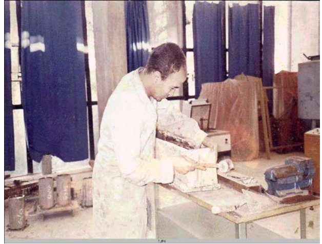
Fig.1 :Tamisage et lavage des granulats et réalisation du coffrage
