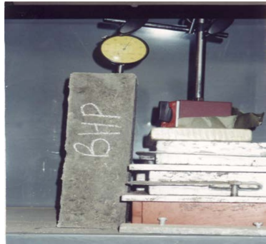
Fig.7 :Retrait des éprouvette(7*7*28)
