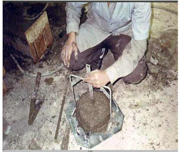
Fig.3 : essai au cône d'ABRAMS
