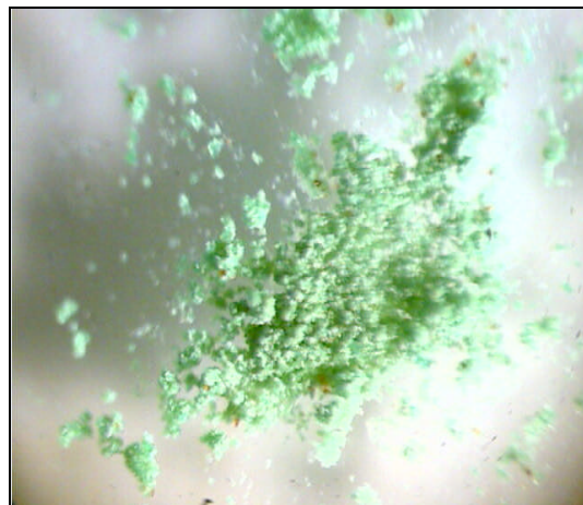
Fig. 32. Observation du complexe [\text{Cu}(\text{BTP})_2]\text{Cl}_2 \cdot 5,5\text{H}_2\text{O} par microscope optique
