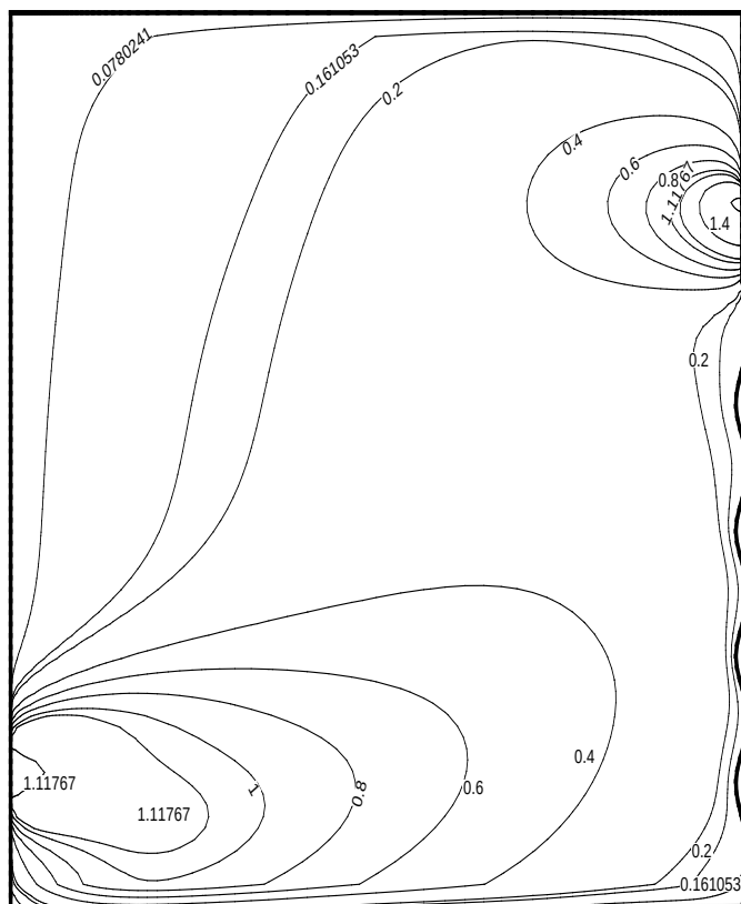
Fig.IV.20 : Distribution de l'énergie cinétique turbulente k pour amplitude a=0.005 m
