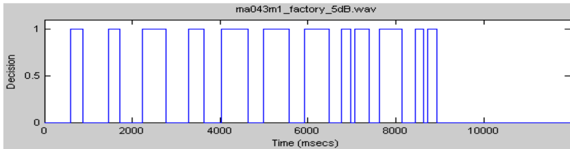
Figure 4.85 : Courbe VAD de l'enregistrement "ma042m1.wav" bruité à 5dB avec du bruit d'usine avec temps de maintien et ajustement du seuil
