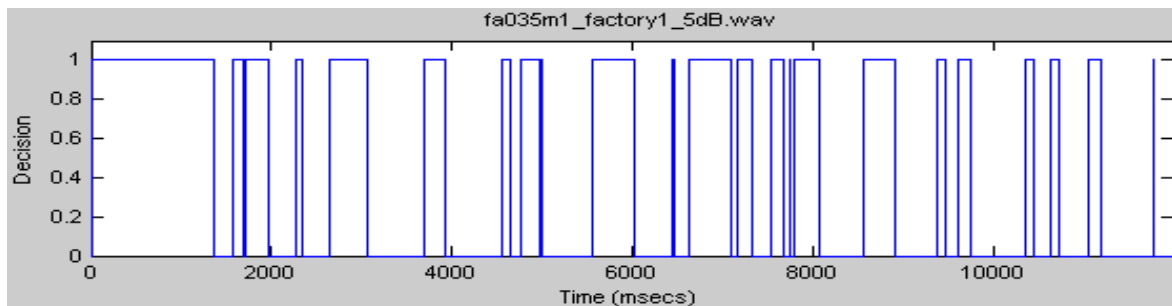
Figure 4.76 : Courbe VAD de l'enregistrement "fa035m1.wav" bruité à 5dB avec du bruit d'usine
