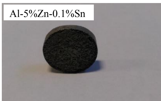
Figures III.D.4 Macrographies des surfaces corrodées après immersion des alliages ternaires durant 15 jours dans NaCl 3%. (a) alliages Al-5%Zn-0,1%Sn, (b) Al-5%Zn-0,1%Bi.
