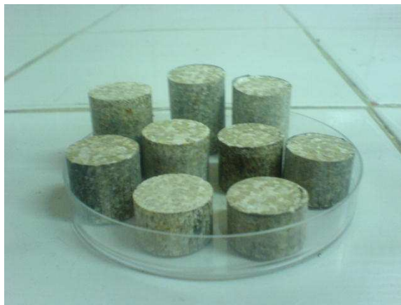
Figure II.14. Pastilles d'argile élaborées avec des densités sèches variables.
