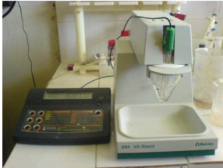
Figure III.10. Photo de l'appareillage utilisé pour le titrage potentiométrique acido-basique.
