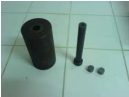
Figure II.13. Matrice et poinçon de compactage utilisés pour l'élaboration des pastilles d'argile
