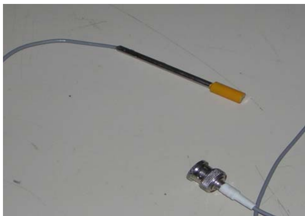
Figure 5-2 : Dosimètre à semi-conducteur utilisé pour les mesures de doses relatives.
