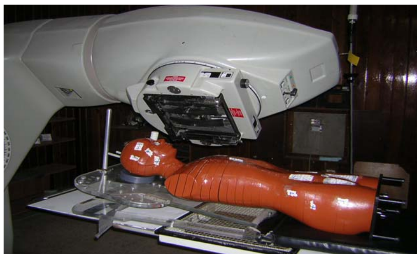
Figure 5-11 : Position d’irradiation du fantôme Rando–Alderson.
