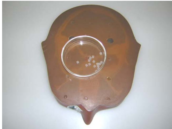
Figure 5-9 : Dosimètre TL utilisés pour la détermination des doses dans le fantôme anthropomorphique
