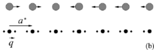
Figure AII-1 : Exemple de structure (a) commensurable et (b) incommensurable.
