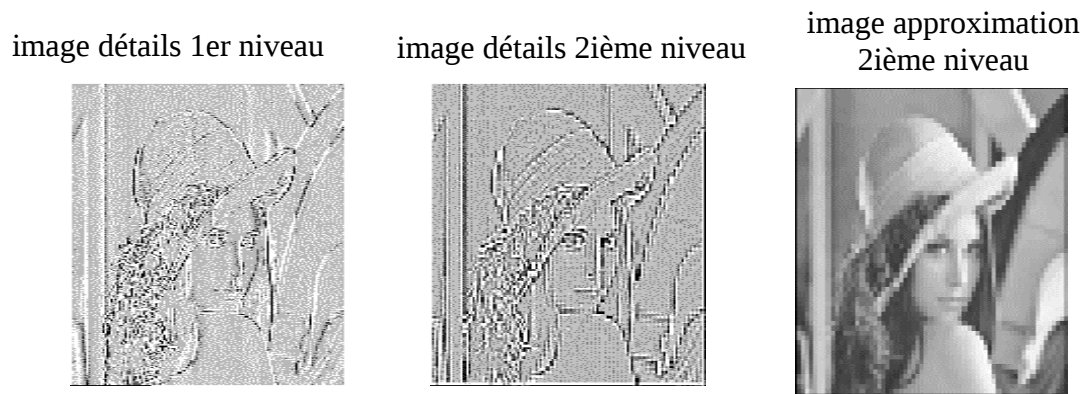
Fig 1.9 représentation de la transformation en ondelettes de l'image de la figure 1.7 selon l'algorithme à trous
