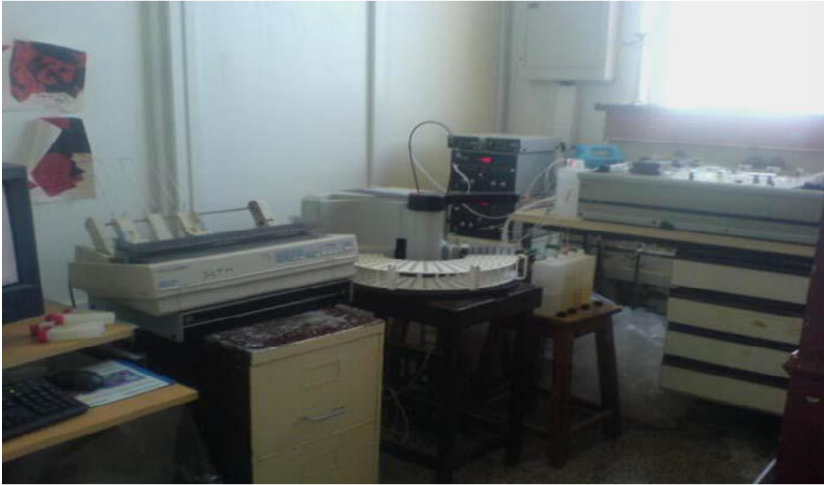
Figure 9 : L'appareil SAN PLUS d'analyse des sels nutritifs
