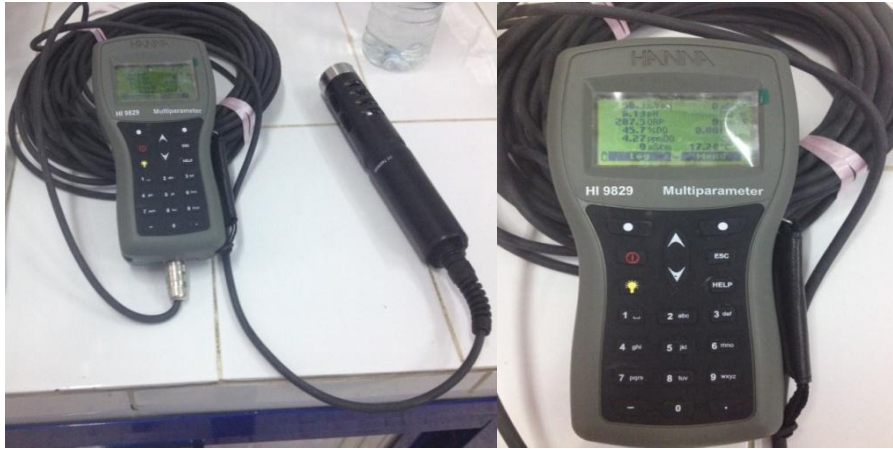
Figure 7 : Valise multi-paramètres utilisée pour la mesure des paramètres physico-chimiques
