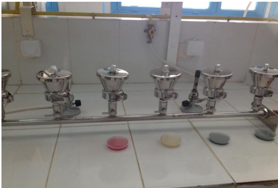
Figure 12: Dispositif de filtration sur membrane.
