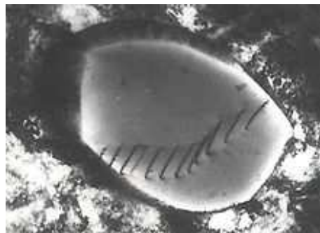
FIGURE 5.5 – Dislocations vues au microscope électronique en transmission.
