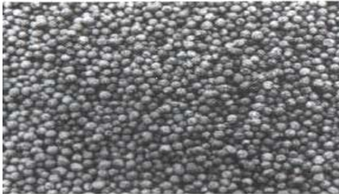
Figure (I.3) : Milieu poreux non consolidé.
