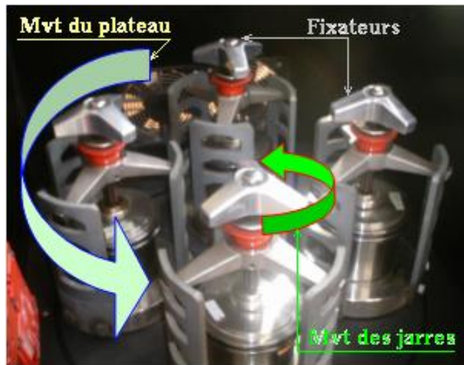
FigureII-2: Présentation schématique du mouvement du plateau et les jarres.
