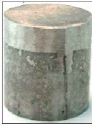
Figure I-32 : Plot (Ø19, h19) constitué d'un assemblage Al/Al 2 O 3
