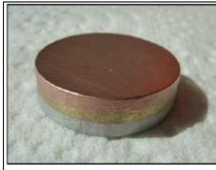
Figure I-30 : Assemblage aluminium/laiton/cuivre réalisé par SPS
