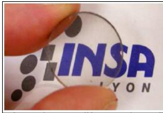
Figure I-34 : Disque de spinelle transparent [134]
