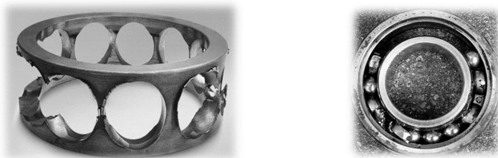
Figure II.20 Rupture de cage de roulements
