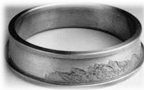
Figure II.18 Écaillage de la bague interne de roulement
