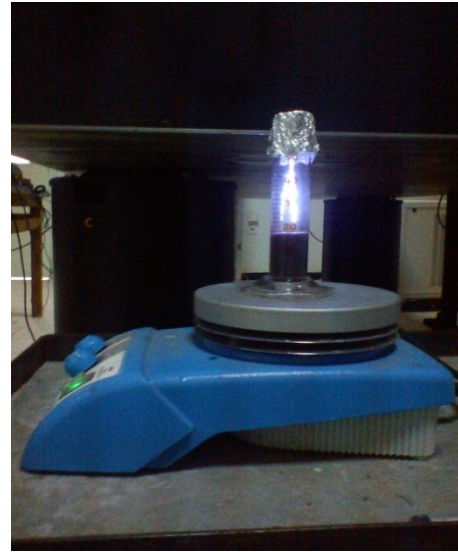
Figure II.7 . Photos montrant l'expérience de la fracturation laser de microparticules en milieu liquide, (le faisceau observé est celui de laser Nd YAG).
