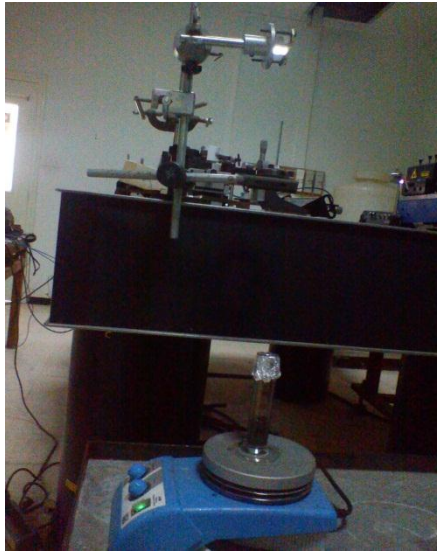
Figure II.7 . Photos montrant l'expérience de la fracturation laser de microparticules en milieu liquide, (le faisceau observé est celui de laser Nd YAG).
