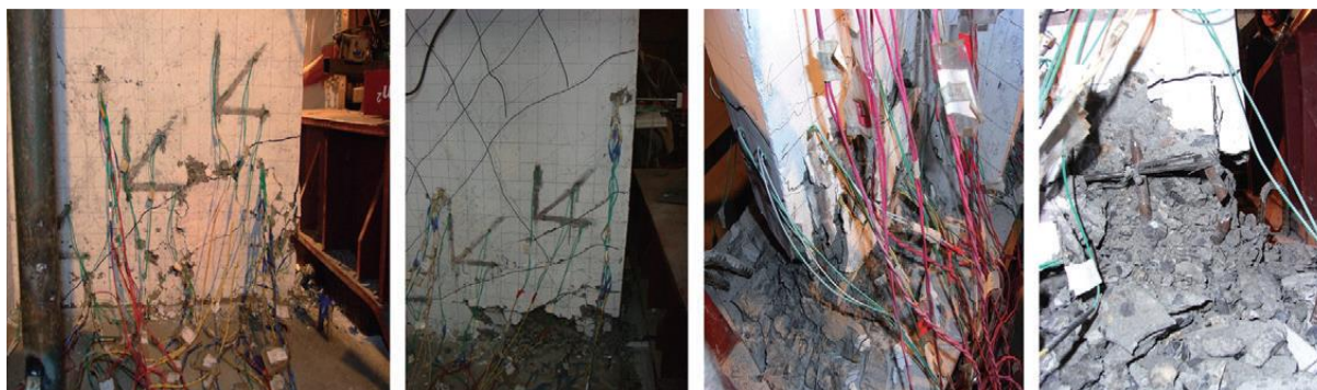
Figure 2.12 : Distribution des fissures du type de voile DL2 (rapport de 2.8)
