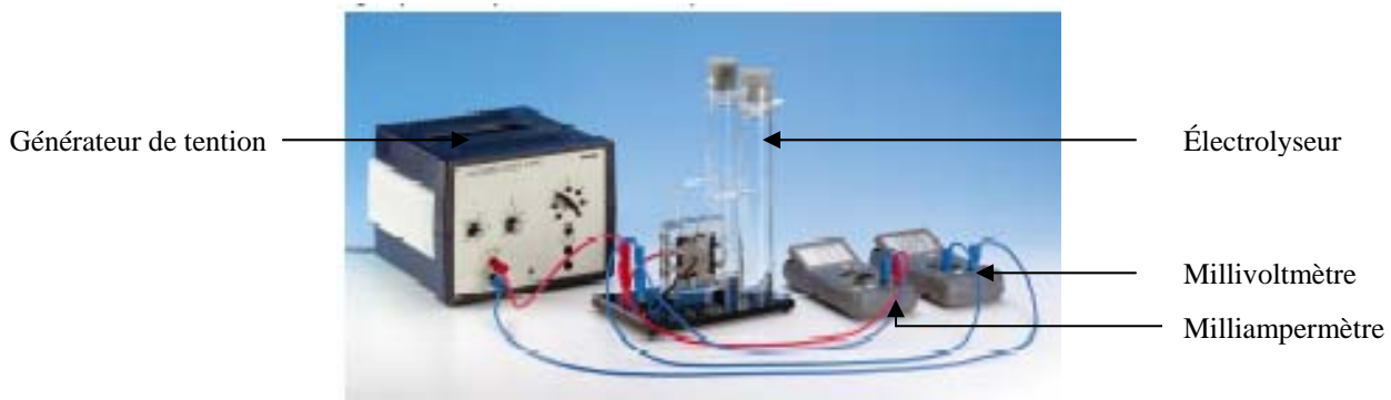
Photo n°III.2 Dispositif expérimental pour caractériser l'électrolyseur
