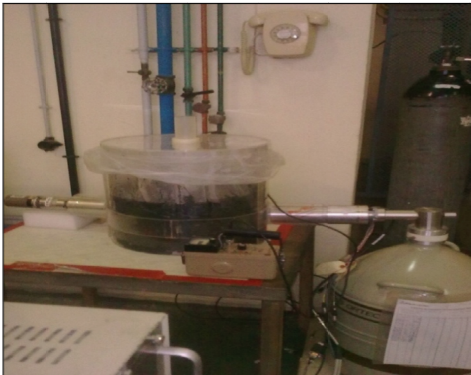
Figure IV.7 : System de détection utilisé pour l'analyse des boues
