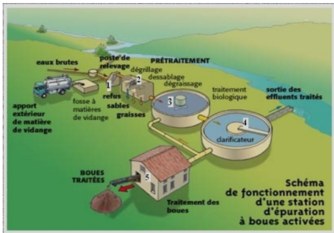
Figure IV.6 : Le fonctionnement d'une station d'épuration
