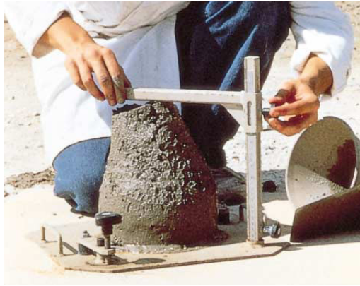
Figure IV.6 : Mesure de l'affaissement
