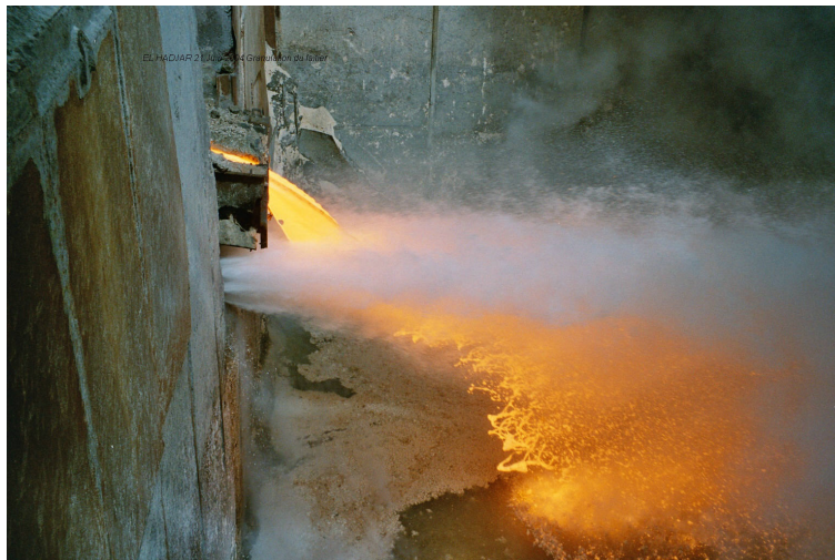
Figure II.2 – Granulation et trempe du laitier à sa sortie du haut fourneau d’El Hadjar
