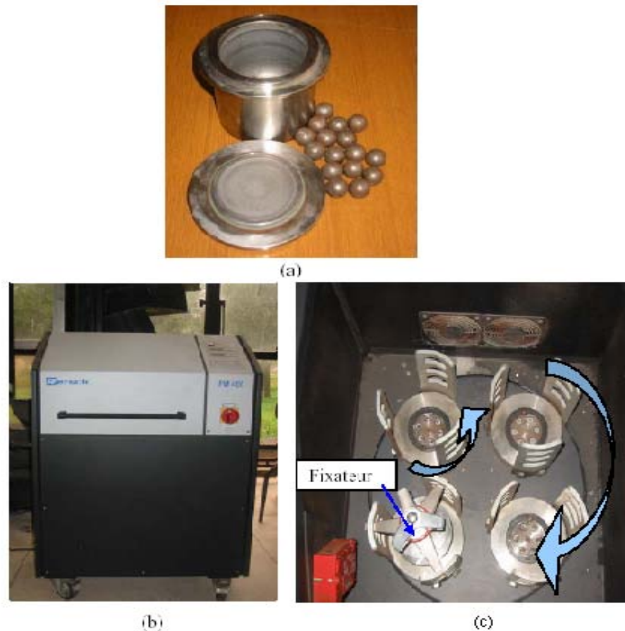
Figure II.1 : Photographie du broyeur planétaire. (a) Photographie de la jarre et des billes (b) broyeur planétaire FRITSCH PM40, (c) Présentation schématique du mouvement du plateau et des jarres.
