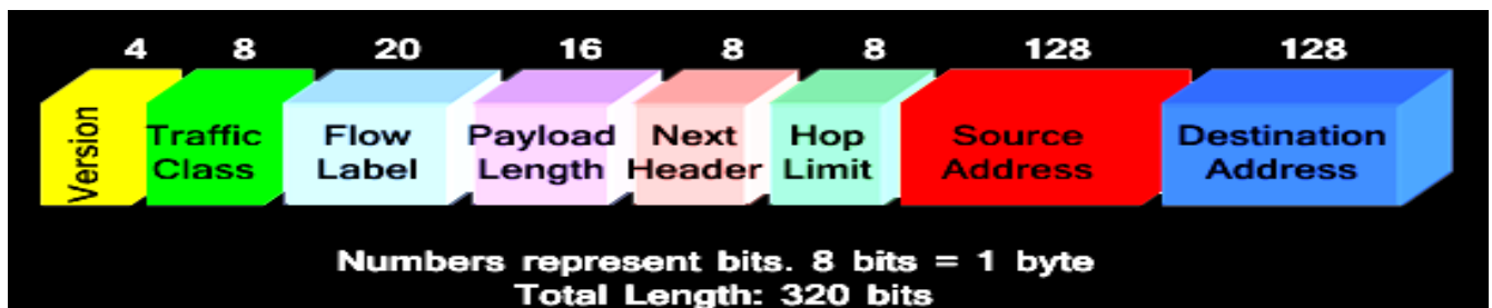
Figure 3.14 : L'en-tête IPv6 standard
