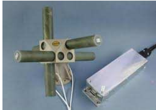
Fig. II.3 : Instrument Magnétique Search Coil avec le préamplificateur associé [Parrot et al., 2006b].
