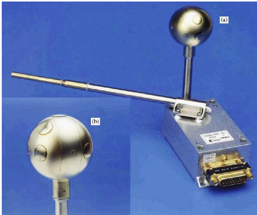
Fig. II.5 : Instrument Sonde Langmuir (ISL). (a) sonde cylindrique (0.6 cm de diamètre et 5 cm de longueur), (b) sonde sphérique segmentée (0.4 cm de diamètre) [Lebreton et al., 2006].
