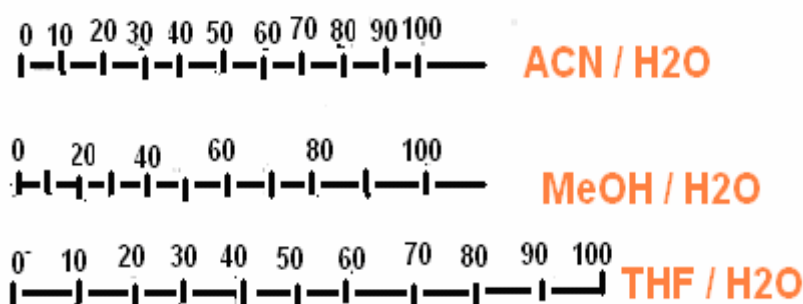
Figure (IV-4) : Force éluante des solvants les plus utilisés en chromatographie liquide à polarité de phase inversée.
