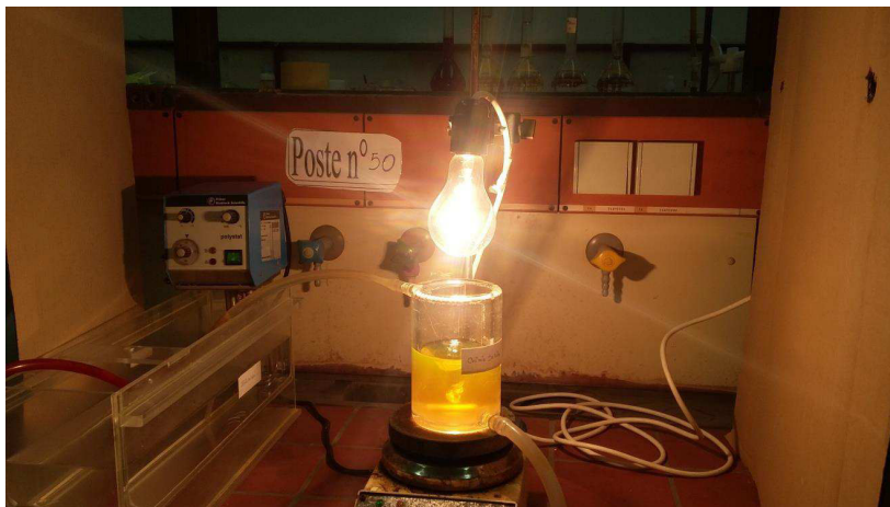
Figure II.6 : Montage expérimental utilisé pour évaluer la photo-activité.
