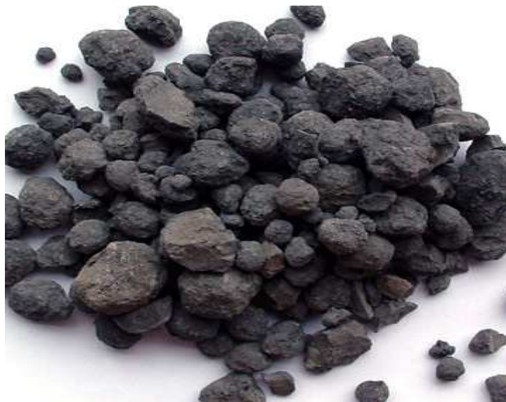
Figure I.3 Aspect de clinker après refroidissement
