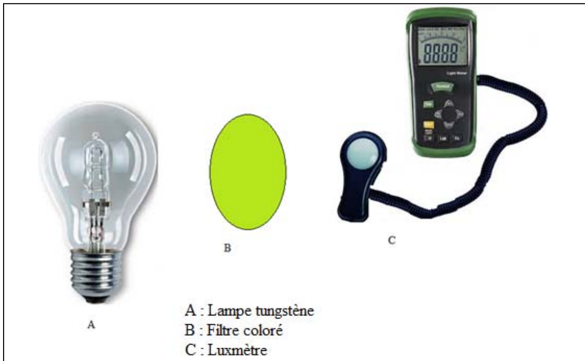
Figure IV. 8 : Dispositif permettant la mesure du flux lumineux émis par la lampe de tungstène.
