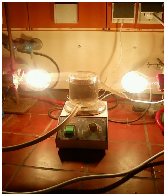
Figure IV. 1 : Dispositif pour la photo-réduction des nitrites
