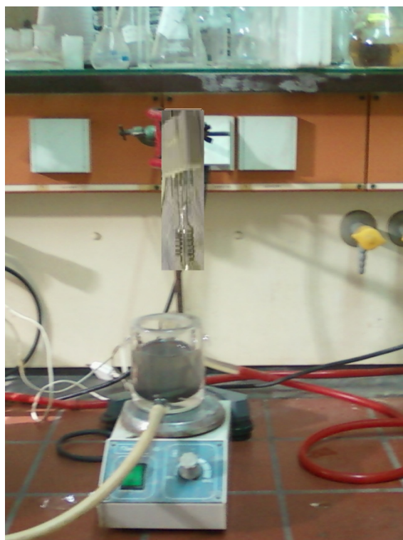
Figure IV. 17 : Dispositif permettant la photo-oxydation de ( \text{Cl}^- )
