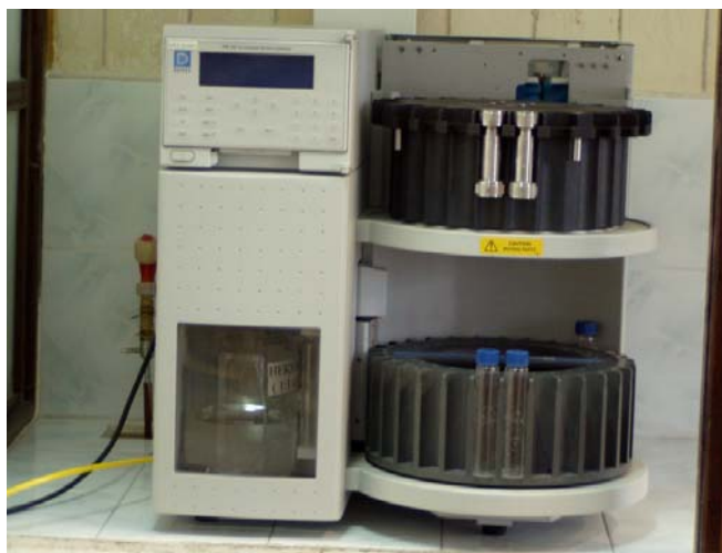
Figure 27 : Extracteur à Solvant Accéléré, utilisé (ASE 200, Dionex )
