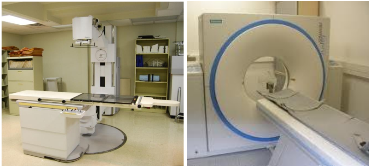
Figure 4.2 : Simulateur et scanner pour l'acquisition des données anatomiques
