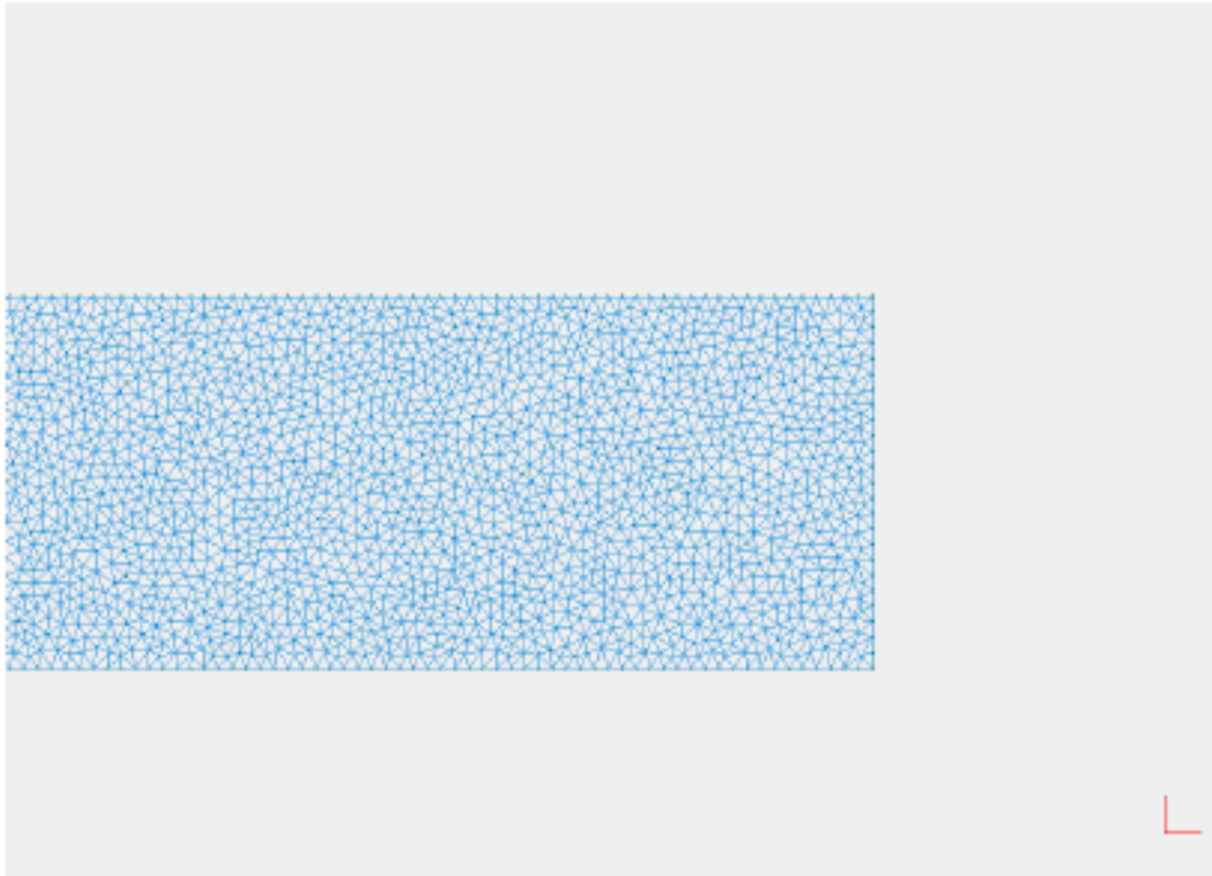
Figure 3-7 : Visualisation du maillage généré par le GMSH sur la poutre
